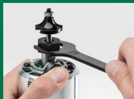
Verrouillage de l'arbre pour un changement de pince facile.
